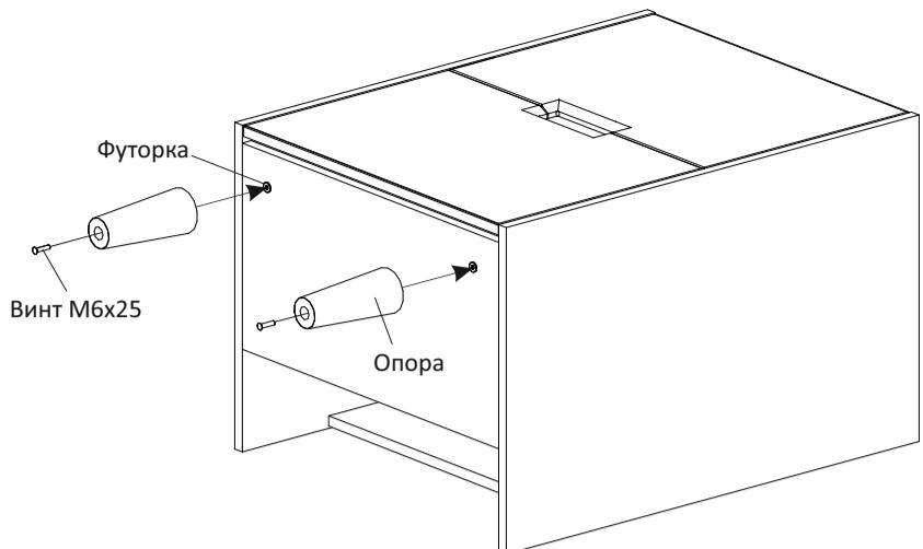
Положить тумбу задней частью на мягкую поверхность. Винт установить через опору в фурточку.
